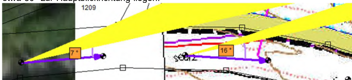
Abbildung 4.2: Blickwinkelanalyse der Straße Richtung Großseiboldried (gelb: Reflexionsstrahlen, violett: Fahrtrichtung)
